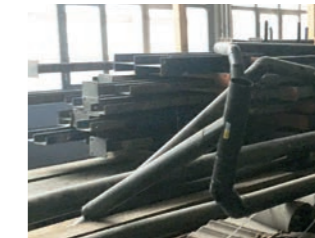
Stahlträger aus dem Bestand
